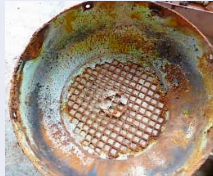
Korrodierte Metallteile von Elektromotoren trotz säureresistenter 2K-Lackierung (links: korrodierte Lüfterhaube, rechts: korrodierte Wicklung)
