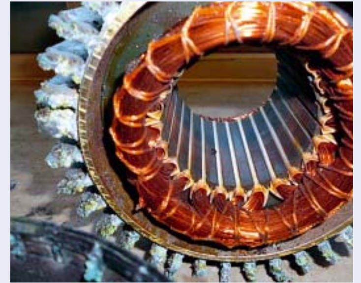
Korrodierte Metallteile von Elektromotoren trotz säureresistenter 2K-Lackierung (links: korrodierte Lüfterhaube, rechts: korrodierte Wicklung)
